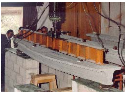
Ensayo de cortante de forjado prefabricado
